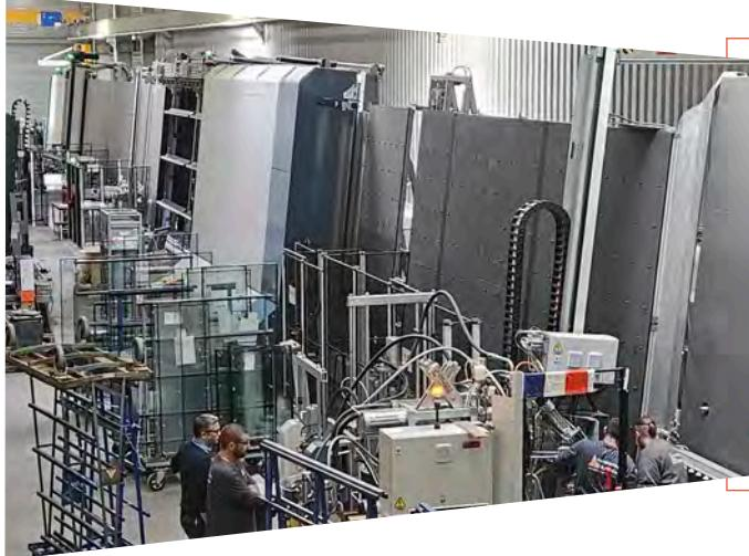
Miroiteries Dubrulle a investi dans une nouvelle ligne de vitrage isolant avec intercalaire cordon souple (T-Spacer™ d'Edgetech).
